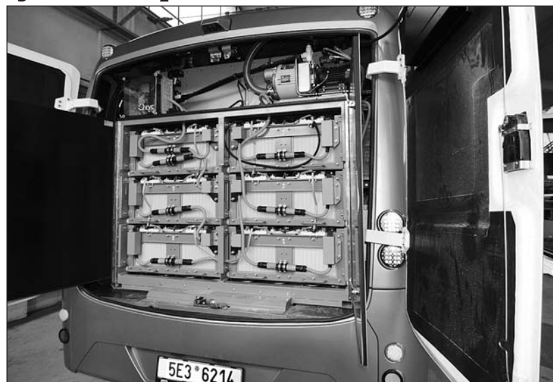
Hradecké ulice křižuje nový elektrobuses, v jehož útroběch je motor o výkonu 120 kW a baterie s kapacitou 172 kWh, která zajistí dojezd až 150 km.
